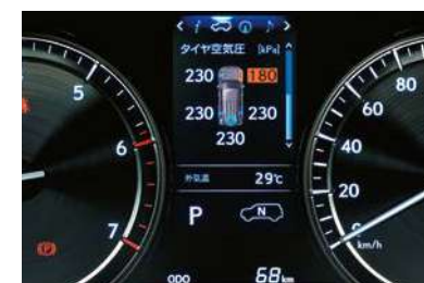
タイヤ空気圧警告表示 (マルチインフォメーションディスプレイ表示付)
