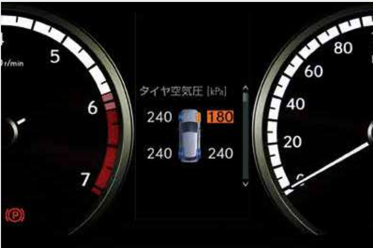
タイヤ空気圧警告表示(マルチインフォメーションディスプレイ表示)* 8
