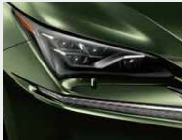
三眼フルLEDヘッドランプ(ロー・ハイビーム) /アダプティブハイビームシステム[AHS] /ヘッドランプクリーナー
