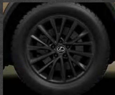
235/60R18 103H “OVERTRAIL” 専用 オールテレンタイヤ&18×7½J “OVERTRAIL” 専用アルミホイール (マットブラック塗装)
