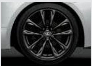
フロント235/40R19+リヤ265/35R19 タイヤ & "F SPORT" 専用アルミホイール (スーパーグロスブラックメタリック塗装)*1
