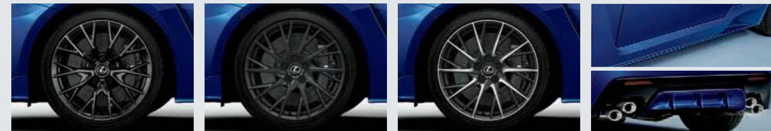
鍛造アルミホイール (BBS製・スーパーグロスブラックメタリック塗装・10本メッシュスポーク)
