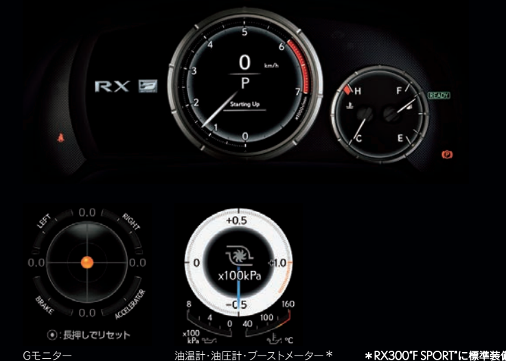
Gモニター 油温計・油圧計・ブーストメーター* *RX300 F SPORTに標準装備。
