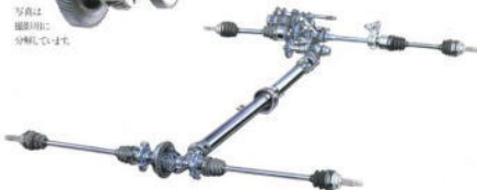
電制式センターデフの機構のクローズアップ。写真の全周線などで1輪が浮いた場合でも、センターデフのゲージが上昇し、前後ともに駆動力をキープ。
