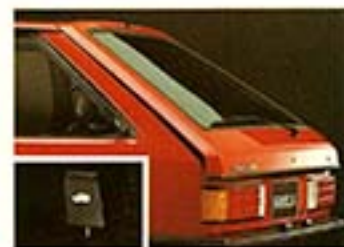
リアゲートオープナー 運転席に居ながらリアゲートを開けられます。操作は、運転席右下のスイッチを動かすだけの容易。(XCを除く)
