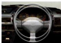
●チルトスタアリング ステアリングの位置を上下に30mm調整可能。体格にあわせて最適なドライビングポジションが得られます。(XE, XG)
