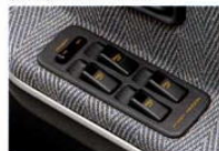
●パワーウィンドウ スイッチ形式は押しとウィンドウが上がり、引くと下がるタイプです。車内で小さなお子様を乗せてスウィッチに当たるとウィンドウが閉まらない安全設計。(XG)
