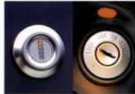
●イグニッションキー/ドアキーリリンダー 照明 ドアのアウトバーハンドルを引くとキーリリンダーとイグニッションスイッチに照明がつき位置を知らせます。(XE, XG)
