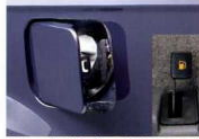
●フェルエルリッドオープナー 運転席からのレバー操作で後部ドアをオープンできます。(XE, XG)
