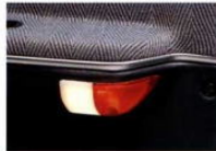
●イルミネーションエントリーシステム ドアを開けるとランプとドアアタックランプが点灯。閉めると5秒後に自動消灯します。(XG)
