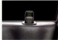
●パワードアロック 運転席のドアロックですべてのドアがロック/ロック解除ができます。(XG)
