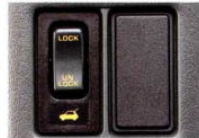
●リアアタックロック&リリース 運転席からリアアタックロック/ロック解除ができます。(XE, XG)
