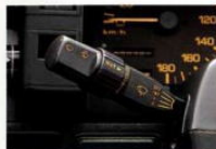
●開閉時間調整式ワイパー ワイパーの開閉時間が1.5秒から10秒まで無段階に調整できます。(XG)
