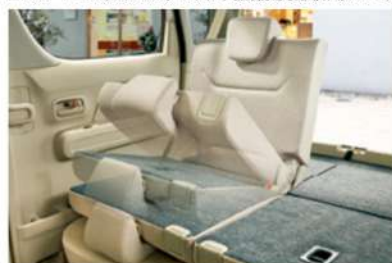
■リアシートワンタッチダブルフォールディング機構(分割可倒式)作動イメージ図
