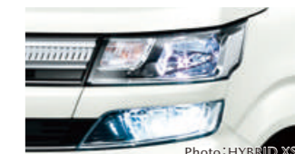
■LEDヘッドランプ (ロービーム:オートレベリング [光軸調整]機構付) [標準装備:HYBRID XS]
