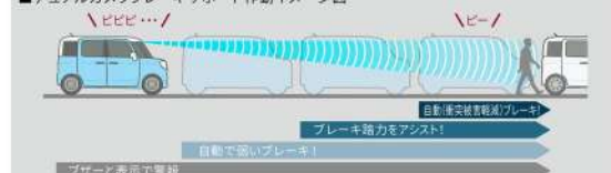
■デュアルカメラブレーキサポート作動イメージ図
