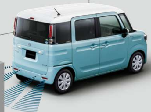
■誤発進抑制機能[後退時]作動イメージ図
