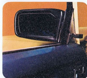
■内側から調節できる可倒式ドアミラー。
