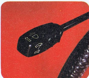
■コンビネーション・スイッチ 方向指示器。ディマースwitch。ヘッドライト。ワイパー（間欠式・2スピード）
