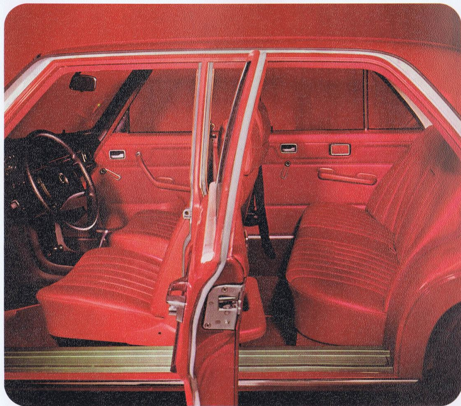
■広く乗心地の良いパッセンジャー・ルーム ボデーは扱い易いサイズで回転半径はわずか5.49m、シートは医学的見地から設計された形で硬すぎずしかも柔かすぎず快適で
