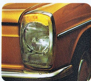
■ヘッドライトケースには、ハイ・ロービームライト、プリンカー、インディケーター、フォグランプが格納されています。
