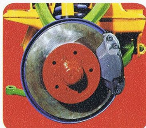
■ オールモデルに4輪パワーデイスク。2回路システム式ブレーキを採用。
