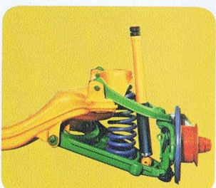
■ フロント・アクスル アンチノーズダイブ付きダブルウィッシュボーン・タイプ
