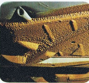
■下回り、泥よけ、サイドシール、フロントセクションの下側に対して、1台につき約14kgの永久シールを施しています。
