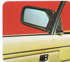
■ 内側から調節できる可倒式ドアミラー。
