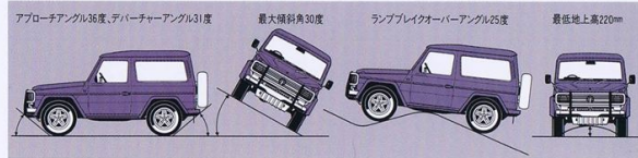
アプローチ角36度、デパーチャー角31度、最大傾斜角30度、ランプレイクオーバー角25度、最低地上高220mm
