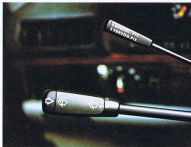
↑ クルーズコントロール及びコンビネーションスイッチ。
