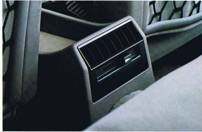
リアシート用フレッシュエア吹出し口
