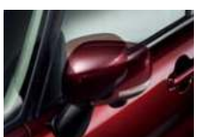
電動格納式リモコンドアミラー [リモート格納]
