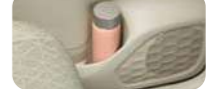
アッパーグローブボックス(引き出し式/助手席側) M G T
