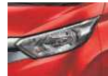
ハロゲンヘッドライト (光軸調整機構付)
