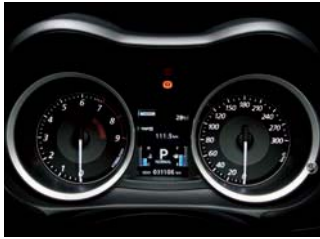
ハイコントラストメーター Photo: TC-SST車
