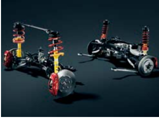
マクファーソンストラット式フロントサスペンション /マルチリンク式リヤサスペンション Photo: GSR-Premium
