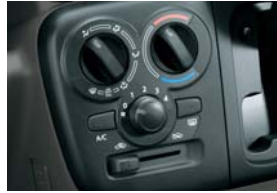
マニュアルエアコン(抗菌処理 タイプ/エアフィルター付)
