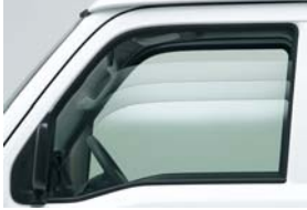
フロントパワーウィンドウ (運転席セーフティ機構付ワンタッチ式) (ブラボーターボ/ブラボーターボ/G)
