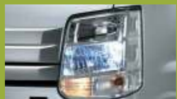
ディスチャージヘッドライト (ロービーム・光軸自動調整機構付)
