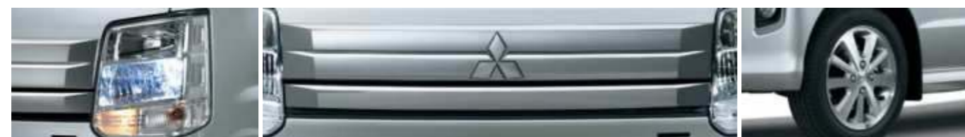
ディスチャージヘッドライト (ロービーム・光軸自動調整機構付)
