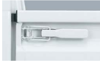
大型ゲートハンドル 頑丈で握りやすいので、アオリをがっちりロックできます。
