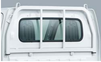
ロープフック付トリイ(ストッパー付) ロープを通して長尺物の積荷をしっかりと固定できます。
