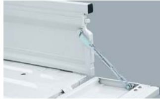
リヤゲートチェーン <G/みのり> リヤゲートを水平にした状態で固定でき、積み降ろしをサポートします。
