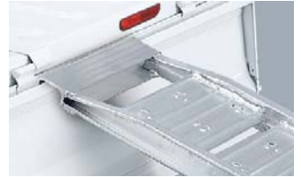
使いやすいリヤゲート リヤゲートにパワーブリッジ(ディーラーオプション)を引っ掛ける溝を全車に設置。重量物の積載時に助かる装備です。
