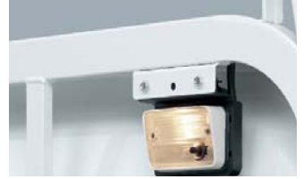
荷台作業灯 <G/みのり> 夜間の積み降ろしなどでも、しっかりと確実に作業することができます。
