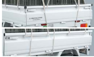
ロープフック 積荷に合わせて多彩なロープがけができ、積荷をしっかりと固定できます。
