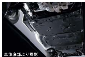
駆動用バッテリーを守るフルフロアアンダーカバー
