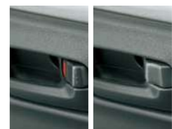
パワードアロック
