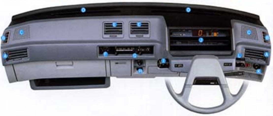
①サイドベンチレータ ②サイドデフロスタ ③スピーカー ④デフロスタ吹出口 ⑤センタベンチレータ ⑥デジタルクォーツ時計 ⑦自動温度調節ヒータコントロールパネル ⑧熱線プリントリヤウィンドスイッチ ⑨ファイバ類スイッチ ⑩液晶式電子メータ ⑪レオスタット ⑫ライト類スイッチ
