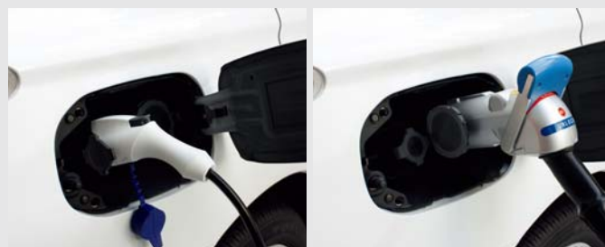
充電口 (左: 普通充電 / 右: 急速充電) 充電口ロックはセンタードアロックと連動
