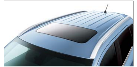
電動ガラスサンルーフ (チルト&スライド・セーフティ機構付)
