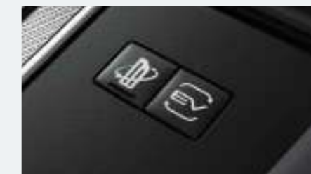
(左側スイッチ)イノベティブペダル オペレーションモードスイッチ (右側スイッチ)EVモードセレクタースイッチ
