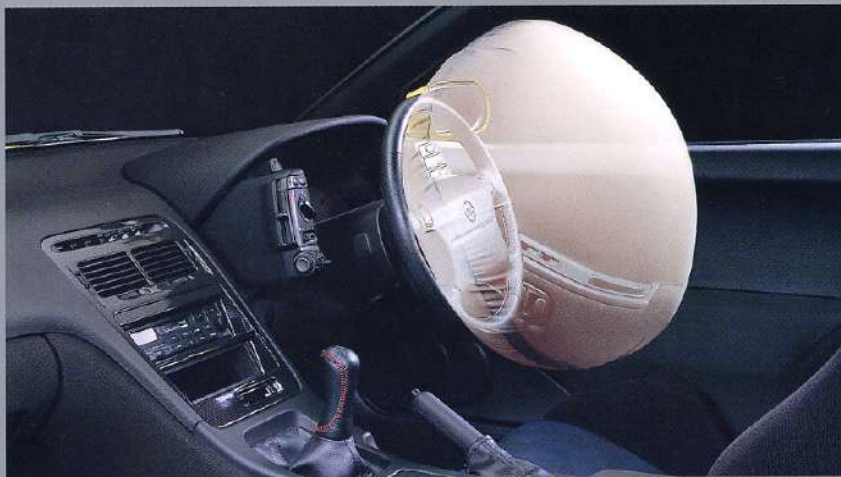
SPSエアバッグシステムは、乗客の安全のために設計された装置であり、衝突時に乗客の頭部や上半身を保護します。
