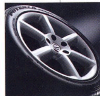
前:18×8Jアルミ ロードホイール (オフセット30) 後:18×8Jアルミ ロードホイール (オフセット30)
