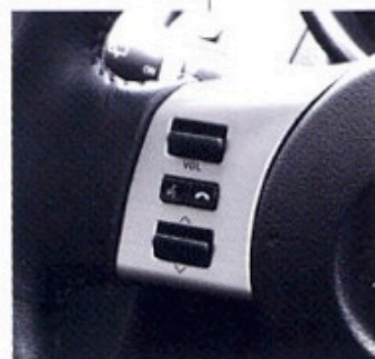
ステアリングスイッチ （オーディオ・ボイスコ マンド・ハンドフリー フォン操作機能付）
