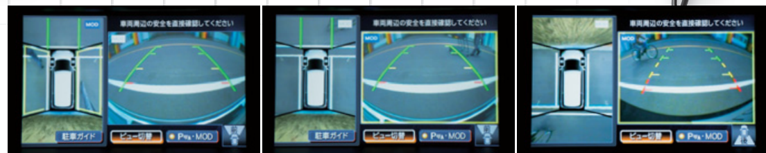
発進前(P or Nレンジ) 車両周辺を表示するトップビュー画面上に移動物があると、ディスプレイ上の表示とともに、音でお知らせします。
