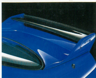
●カーボンセンターリヤスポイラー(角度調整機構付)
