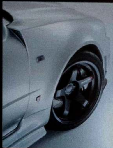
CFRP製フロントフェンダーはGT500レース車両ゆずりの形状とし、標準ボディに対して片側15mm拡大
