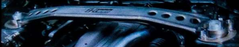
フロントのストラットタワーは「Z-tune」のロゴを配した専用品。重量増を抑えながら剛性アップを図る
