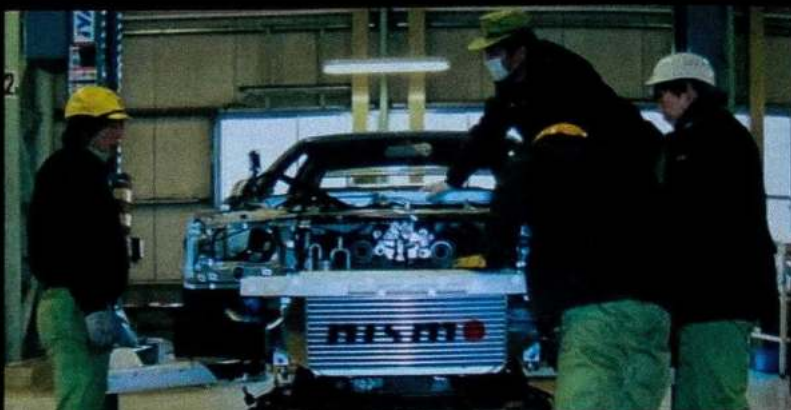
ボディ状態等の諸条件をクリアした車両は改造部位を分解。ボディ補強等を施した後に塗装、組み上げられる
