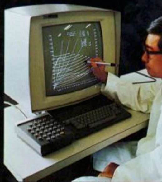
データ変更による特性変化を瞬時に算出するグラフィックディスプレイシステム
