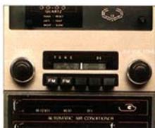
AM/FMマルチラジオ:低周波アンパがFM放送の臨場感を盛上げます。ハードトップ6気筒SGLとセダンのメダリストはオートチューナー付。カスタム系とDXはAMラジオ。
