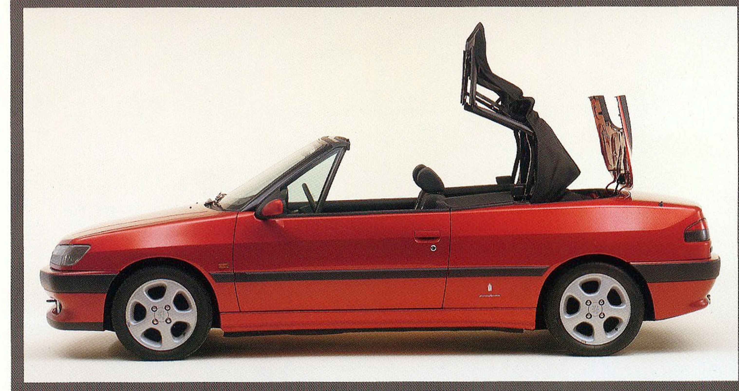
フードの開閉はセンターコンソールのスイッチでワンタッチ。 フルオープンに約20秒、クローズに同じく20秒ほど。きわめて容易だ。
