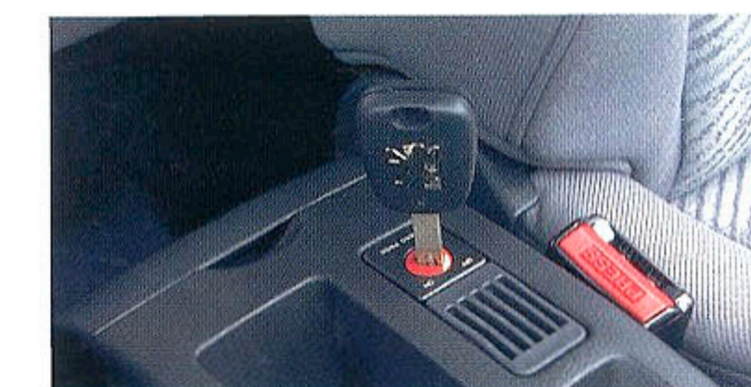
キー操作でOFFにできる助手席エアバッグキャンセルスイッチ。
