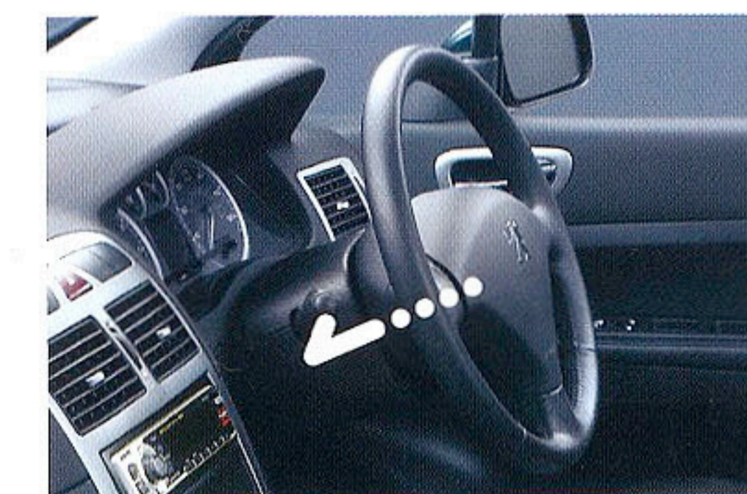
衝突時に最大50mm縮む衝撃吸収ステアリングコラム。
