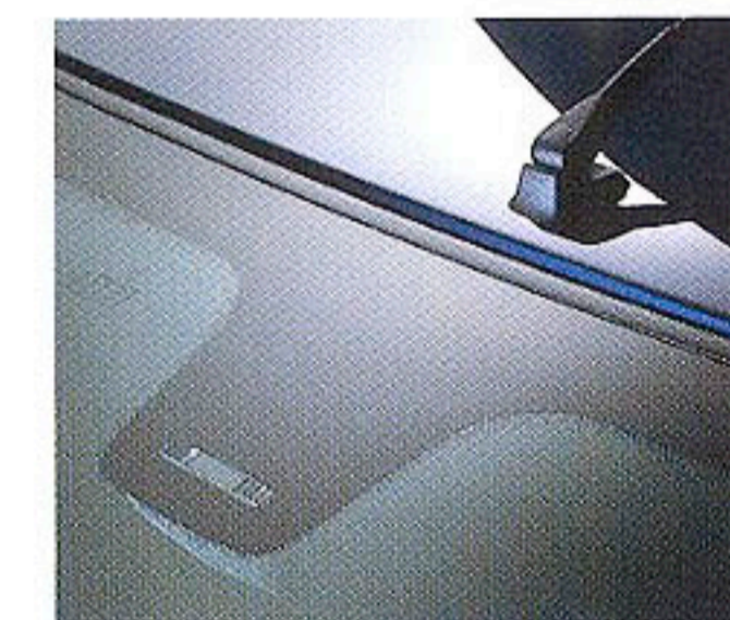
雨滴感知式オートワイパー(SVおよびSVレザージャケット)
