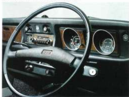
衝撃吸収ハンドル、ステアリングロック装置、パッシングライトなど、いたれりつくせりの安全装備
