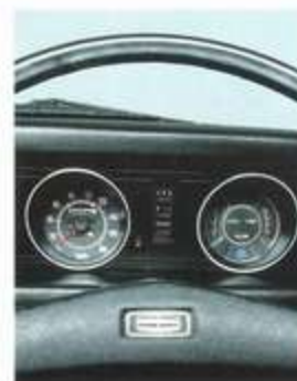
無反射ガラスを採用の見やすい丸型 メーター。トリップメーターつき
