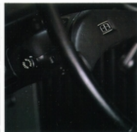
緊急の際に危険を防止する非常点滅表示灯
