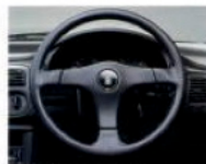
ナルディ製本革巻ステアリングホイール CHX Edition S2 ナルディ製PCA加工Hタイプ、しっかりと手になじむ、 スポーツタイプの本革巻ステアリングホイールです。
