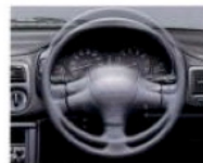
マルチステアリング ステアリングホイールの向きを上とそれぞれ30度の で無段階に調整することができます。
