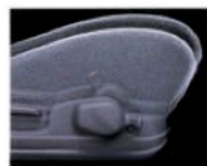
運転席シートワフター(CX) 無段階調整式で、シートの高さを上、下に10mm調整可能
