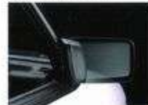
●可倒式リモコンドアミラー(※) 室内からレバー操作によりミラーの調節ができます。駐車時に便利な可倒式。
