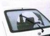
●開けっぴりワイパー&ウォッシャー/熱線プリントリヤデフォグ (※)開けっぴりワイパーはR、Rに。
