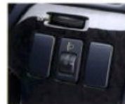
HIDランプ光軸調整スイッチ(RSK) HIDランプ(ロービーム)は、姿勢変化に 応じて運転者から光軸調整が可能。
