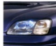
HIDランプ(ロービーム)コグニティブリア(RSK) ハロゲン灯の約40%の消費電力で約2倍の 光量と約3倍の寿命。光線光に近いきを放 つHIDランプをロービームに採用。
