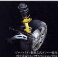
ビルシュタイン製倒立式ダンパー採用ストラット式フロントサスペンション/RSK
