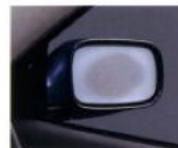
ヒーター付ドアミラー ヒーターにより雨滴を除去し後方視界をクリアにする。
