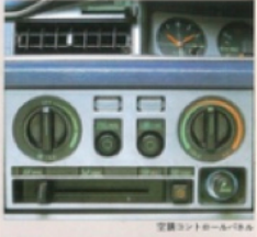
●空調コントロールパネル
