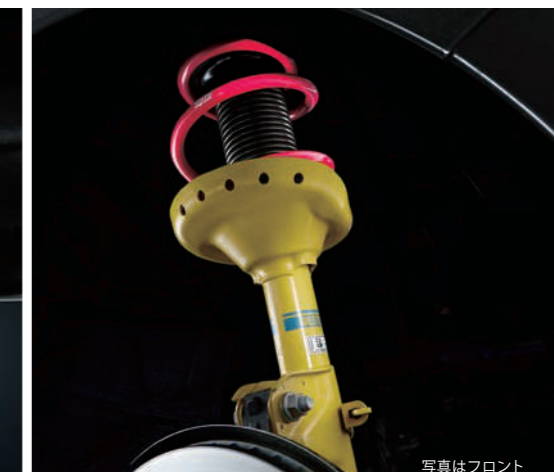
STIチューニング ビルシュタイン製ダンパー (フロント:DampMatic® II、倒立式)&コイルスプリング
