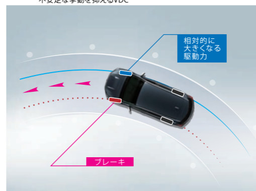
旋回性能を高めるアクティブ・トルク・ベクタリング
