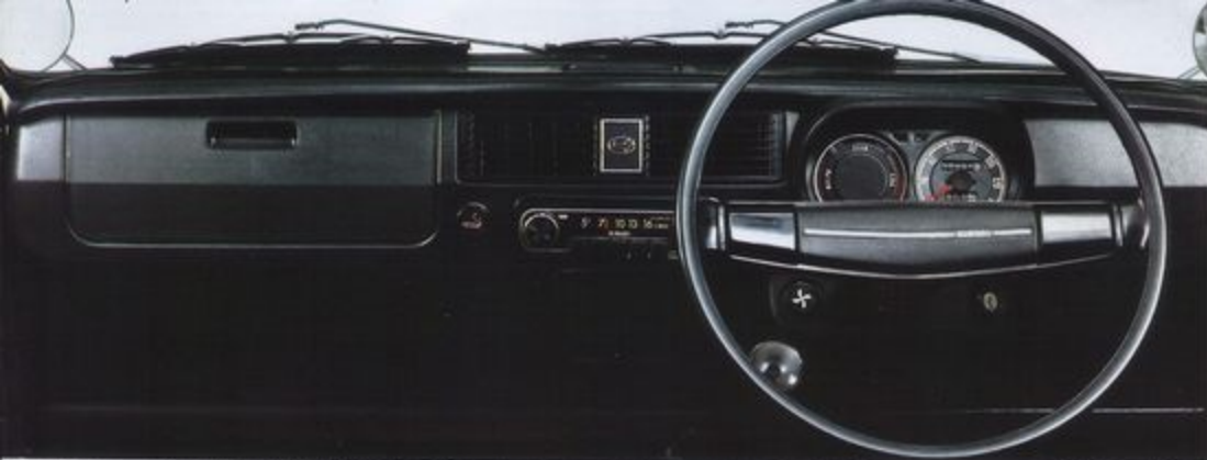
厚いクラッシュパッドで覆われ、防眩処理がほどこされたダッシュボードまわり。見やすいメーターと、使いやすく配置されたスイッチ、ノブ類（3点式シートベルト）
