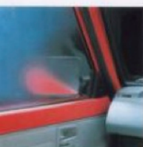
サイドウィンドウの曇りをすばやく除去するパワフルなデフロスター。クリアな側方視界を確保する安全装備です。
