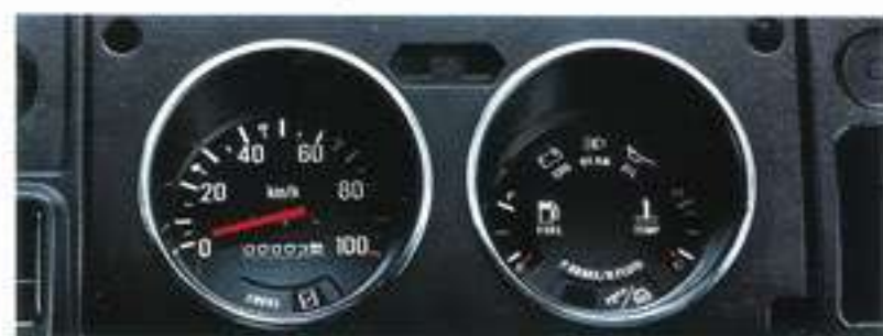
●チョークパイロットランプ 薄く点灯=チョーク操作、明かるく点灯=機完了の2段階表示で、チョークの戻し忘れを防ぎます。
