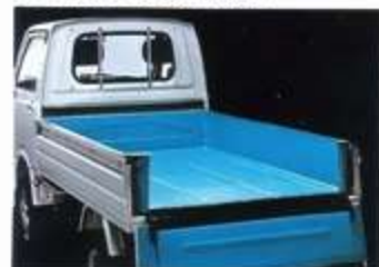
●両合カバー 荷台が水や塩害によって腐蝕されるのを防ぎます。
