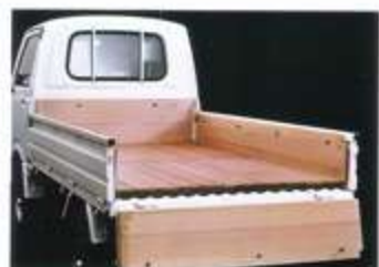
●木製フロア ボディや荷台の傷み防止に効果的。そのうえ横荷もよこしません。
