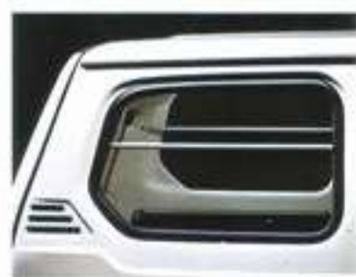
●ガードバー ライトバンの荷室側面ウィンドウは、ガードバー(保護棒)付です。荷ぐれによるガラスの損傷を防ぎます。
