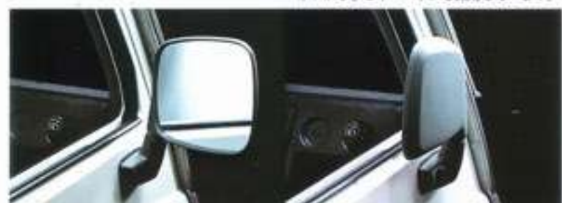
●アウトサイドミラー (正常時) (衝撃時) 衝撃視察式アウトサイドミラーの採用により歩行者の安全をも保護しています。
