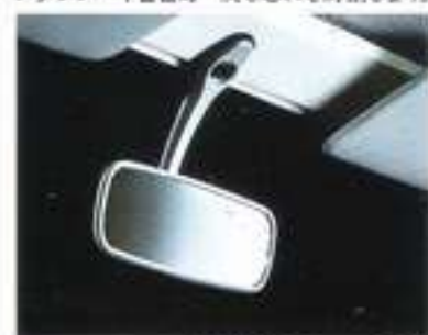
●ルームミラー 衝撃視察式のルームミラーは、万が一の安全対策のひとつ。しかも、後方視界を十二分に確保する大型ミラーです。
