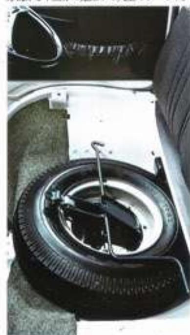
●スペアタイヤ フロントシートの下にジャッキと一緒に格納。雨の日でも積荷をよこすことなく、取りはずしも簡単です。
