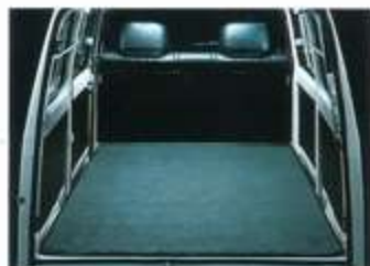
●フラットデッキ キャンピングカーに変身させる レジャー向きパーツ。小物は床下に格納できます。
