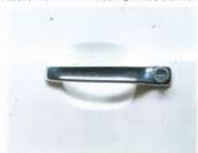
●助手席側ドアキーロック(※) 助手席側ドアにも、外側からロック・オン、ロック・オフができるキーロックを採用しています。
