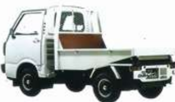
ミニ・フジマイティ (土砂用ダンプ) 軽唯一の本格的なリンク機構を採用。力強く横転作業も便利です。
